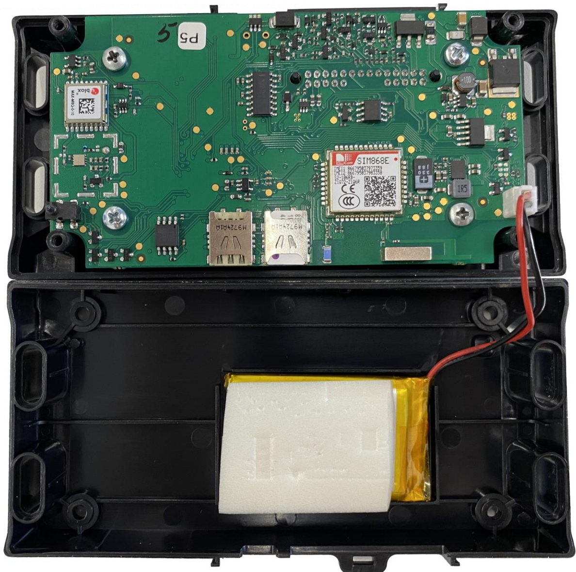
Рисунок 4.3. Подключение аккумуляторной батареи
