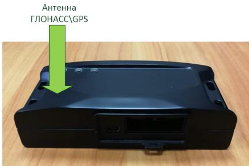
Рисунок 4.5. Ориентация FORT-114М при установке в транспортном средстве
