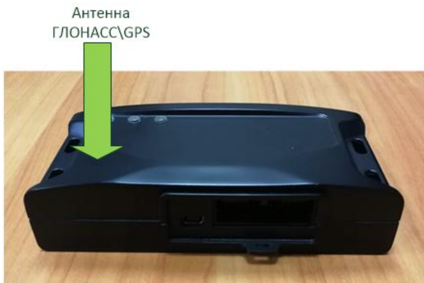
Рисунок 4.5. Ориентация FORT-114 при установке в транспортном средстве
