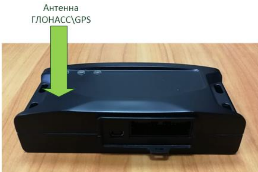
Рисунок 4.5. Ориентация FORT-114 при установке в транспортном средстве
