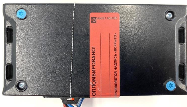
Рисунок 6.1 – пломбирование корпуса пластилиновыми пломбами и интерфейсного разъема пломбой с тросиком
