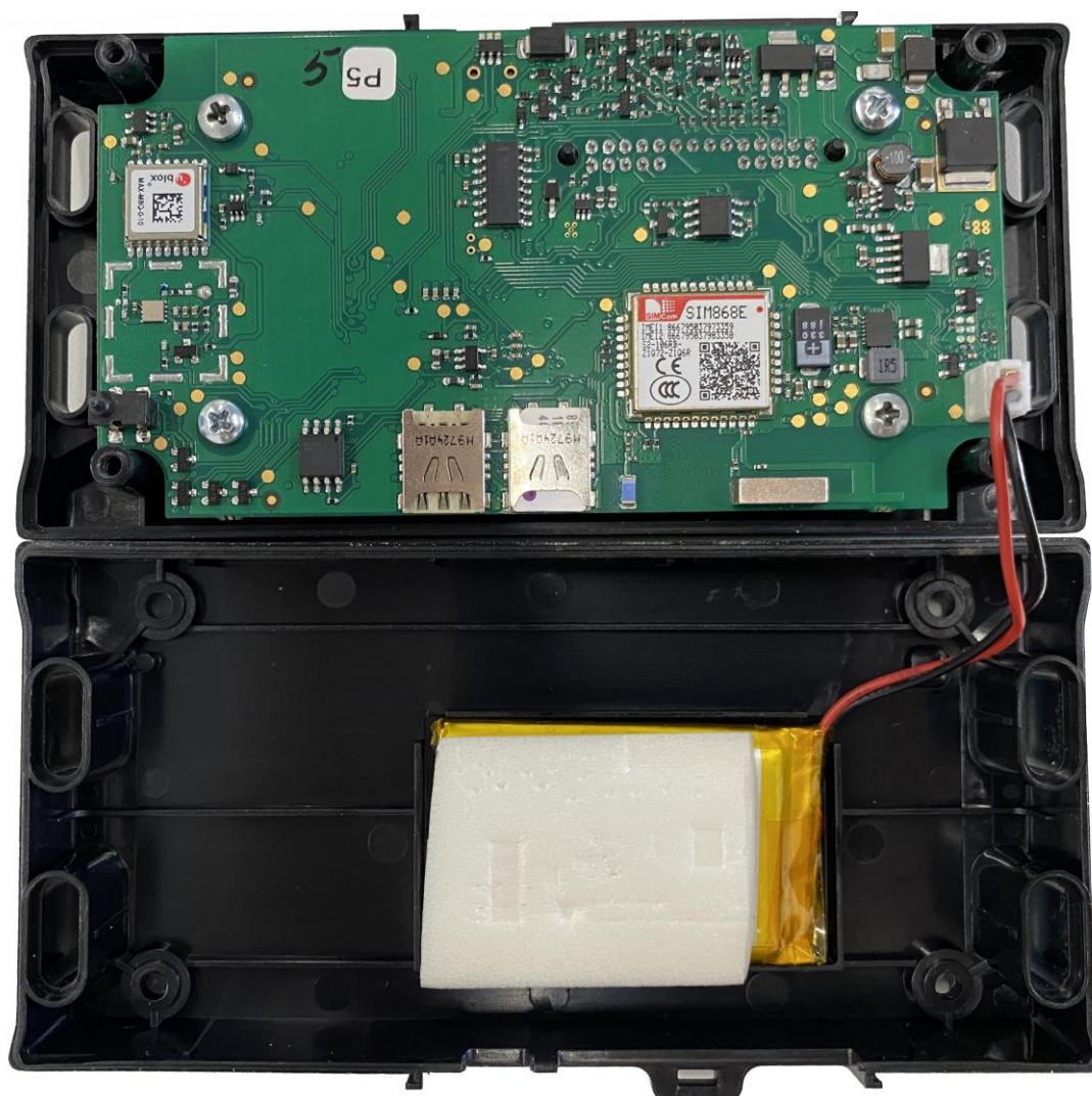
Рисунок 4.3. Подключение аккумуляторной батареи
