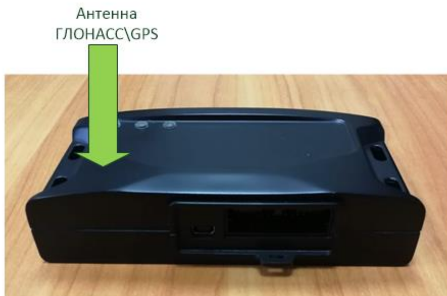
Рисунок 4.5. Ориентация терминала FORT-114M при установке в транспортном средстве
