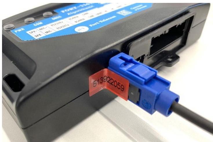
Рисунок 6.4 – пломбирование от несанкционированного отключения GNSS антенны наклейкой
