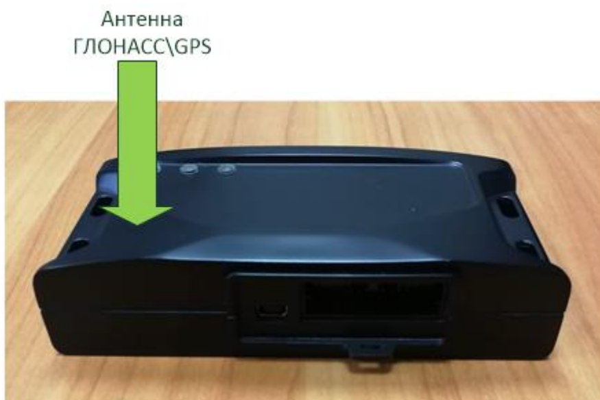
Рисунок 4.5. Ориентация FORT-112M при установке в транспортном средстве
