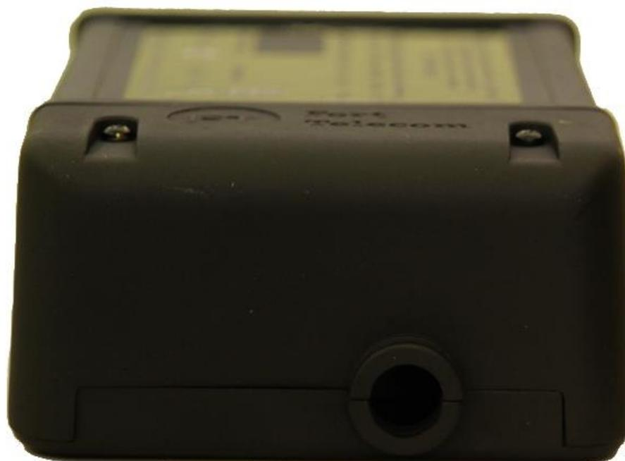
Рисунок 3.3. Крышка задней панели терминала FORT-112Ex
