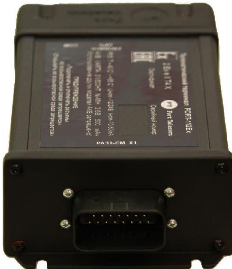
Рисунок 3.1. Лицевая панель терминала FORT-112Ex
